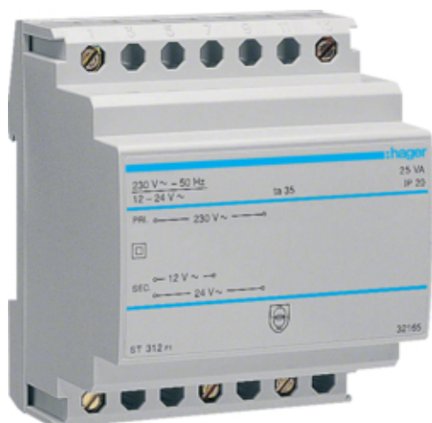
Трансформатор на DIN-рейку, 230В/24 В (1,04А), 230В/12 В (2,08А)
