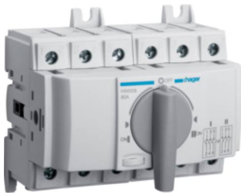
Перемикач трьохпозиційний I-0-II 400/690В, 80А, 3п, 6м
