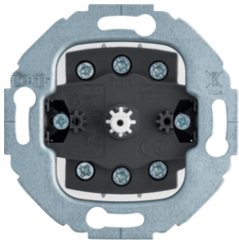
Кнопка поворотна 2-полюсна 10А/250В 1930/Glas/R.classic
