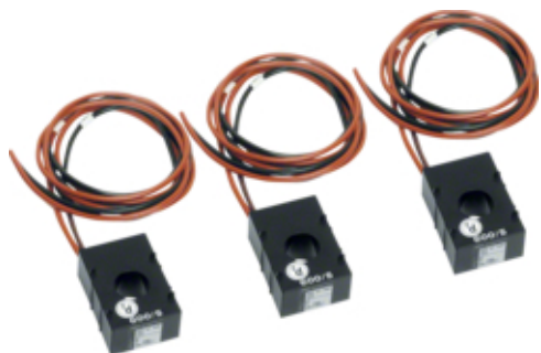
Комплект (3шт) трансформаторів в струму для NH1/2/3, клас-1, 600:5, 5ВА
