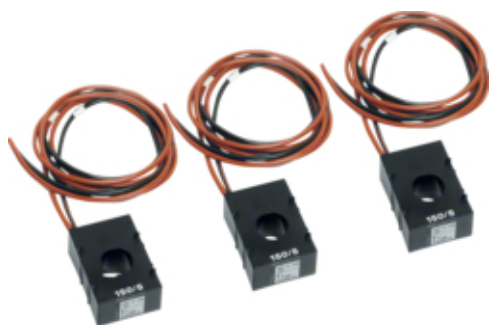
Комплект (3шт) трансформаторів в струму для NH1/2/3, клас-1, 150:5, 2.5VA
